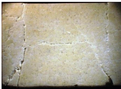
опыт №1, P=31,4 кН, \dot{\epsilon}=200 с -1 ( V_{\text{нагр.}}=4,0 м/с)
