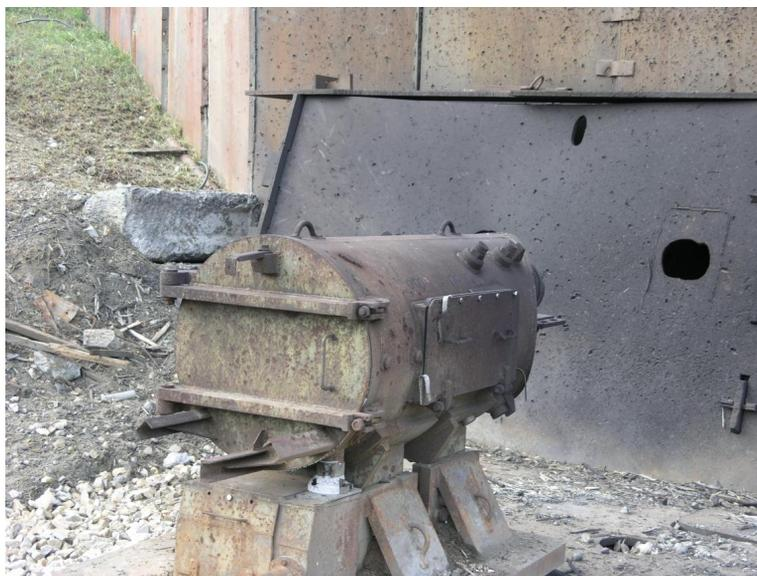
**Рисунок 8.** Взрывозащищённая камера, используемая для размещения регистраторов изображений рентгенографируемого устройства при проведении взрывных экспериментов
