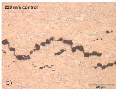
**Рисунок 9.** Микроструктура меди [10] (соударение плоских пластин, амплитуда ударной волны ~2 ГПа)
