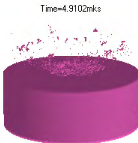
Рисунок 4. Соударение преграды текстолита с алюминиевым ударником: 3-D картина соударения
