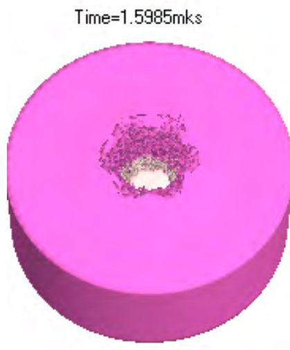
Рисунок 6. Соударение преграды текстолита с ударником из стали: 3-D картина соударения
