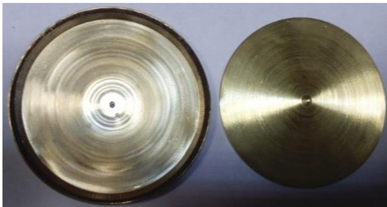
Рисунок 3. Заготовка с буртом (слева) и после обработки без бурта (справа)
