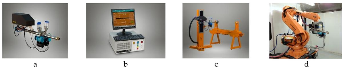
**Рисунок 1.** Детонационный комплекс CCDS2000: а) рабочий орган (пушка), состоящий из ствола, блока газораспределения и порошковых дозаторов; б) блок управления на базе промышленного компьютера; в) пушка в комплекте с 3-х координатным манипулятором; д) пушка на промышленном роботе
