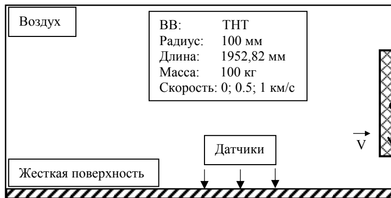
Рисунок 2. Схема расположения заряда ТНТ над жесткой поверхностью
