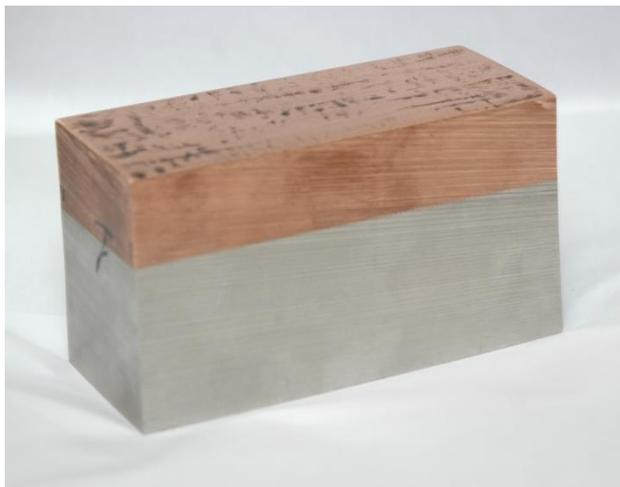
**Рисунок 4.** Фотография заготовки из биметалла нержавеющая сталь – бронза
