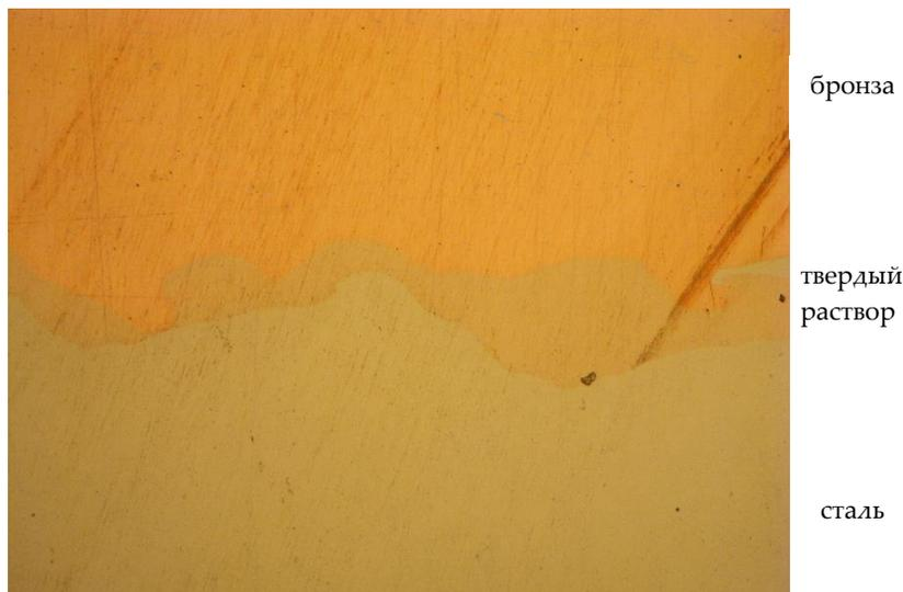
**Рисунок 6.** Фотография микрошлифа контактной границы SS–Br, ув.х200
