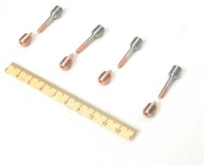
**Рисунок 7.** Фотография образцов после испытания на разрыв
