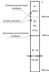
Рисунок 1. Схема МУТ при проведении экспериментов с волнами разрежения
