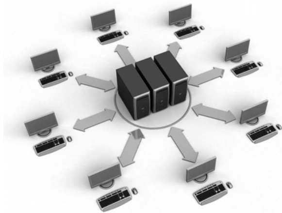
Рис. 1. Модель использования тонких клиентов в сетях с терминальной архитектурой
