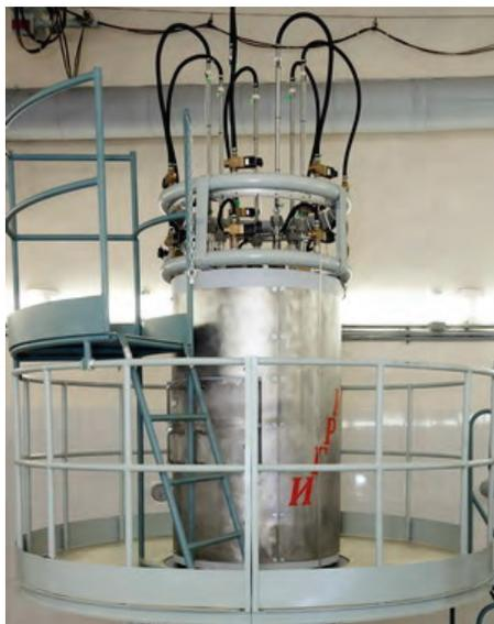
Рис.1. Общий вид корпуса АЗ реактора ИГРИК-2
