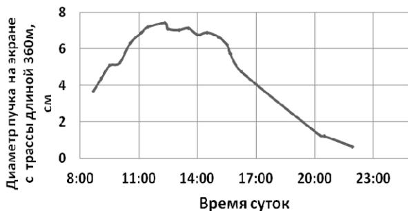
Рис. 6. Зависимость диаметра сфокусированного пучка с трассы длиной 360 м на экране от времени суток в солнечный день
