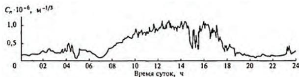
Рис.3. Результаты измерения структурной постоянной  $C_n$  в течение суток
