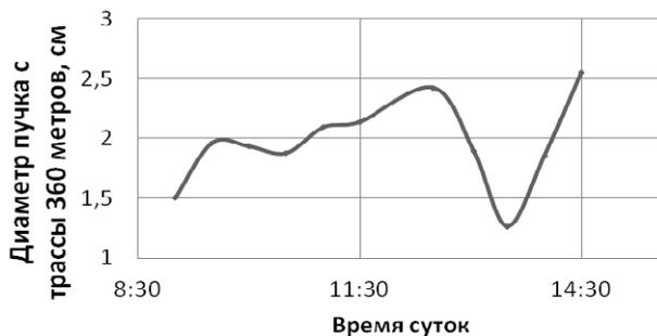
Рис. 8. Зависимость диаметра лазерного пучка от времени суток в пасмурный день
