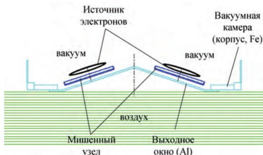
Рис. 2. Расчетная геометрия
