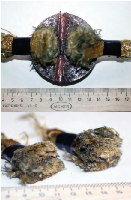
Рис. 7. Рез от ДУЗ, иницированного с торца
