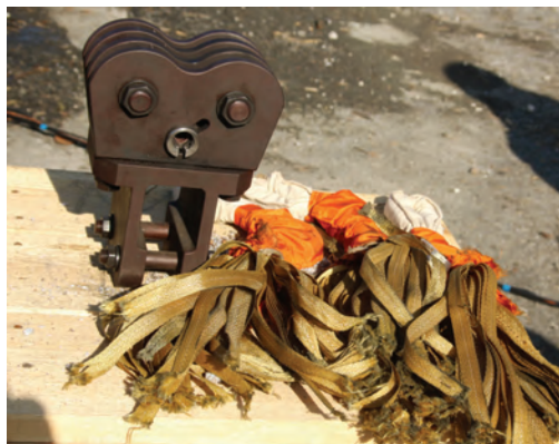
Рис. 14. ЭУ, после испытаний по проверке работоспособности ДУЗ
