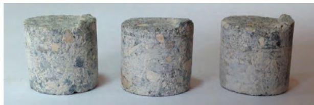
Рис. 13. Образец с дефектом «зуба»
