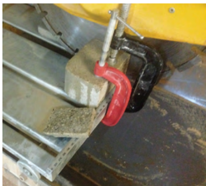
Рис. 11. Заготовка бетонных пластин
