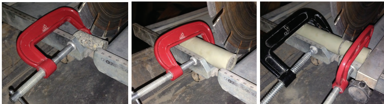
Рис. 10. Закрепление кернов на камнерезном станке
