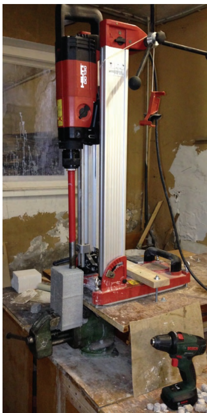
Рис. 9. Закрепление буровой установки и брусчатки
