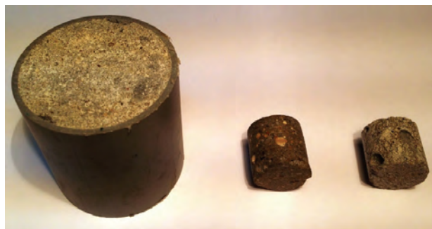
Рис. 8. Фото бетонного образца в пластиковой трубе и с дефектами
