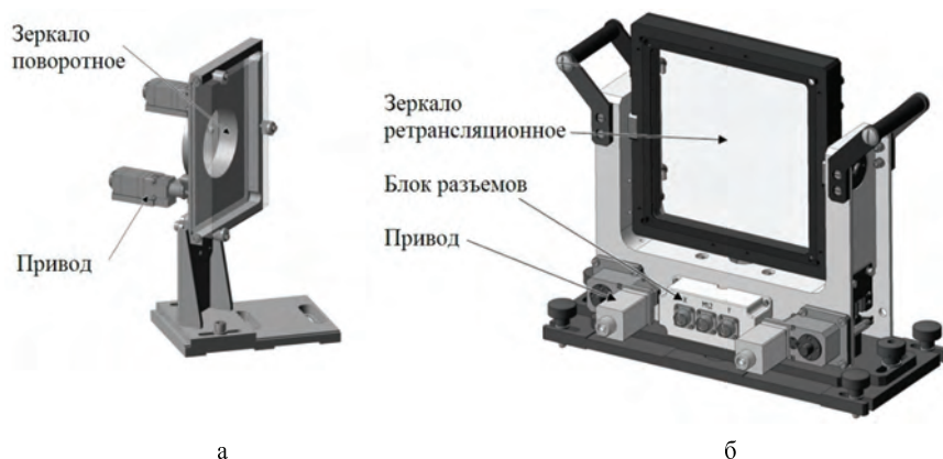
Рис. 4. Оправы: а – оправа зеркала поворотного, б – оправа зеркала ретрансляционного
