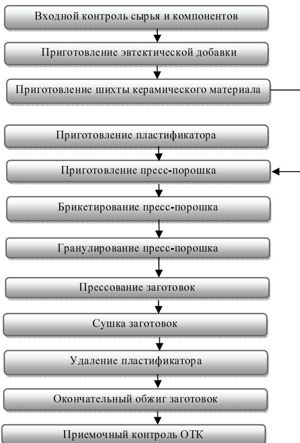
Рис. 3. Блок – схема маршрута изготовления вакуумплотной керамики и изделий на ее основе
