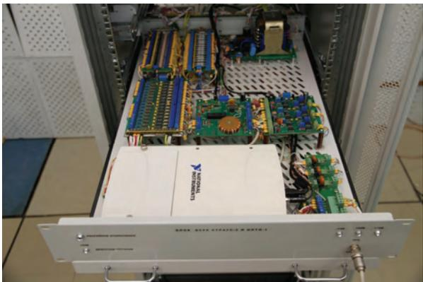
Рис. 5. Выдвижная панель с блоками управления АСУК
