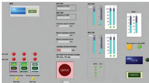
Рис. 9. Мнемосхема модуля «Зарядка» АСУК СТРАУС-2
