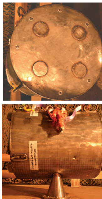
Рис. 7. ТУК-159 после испытаний
