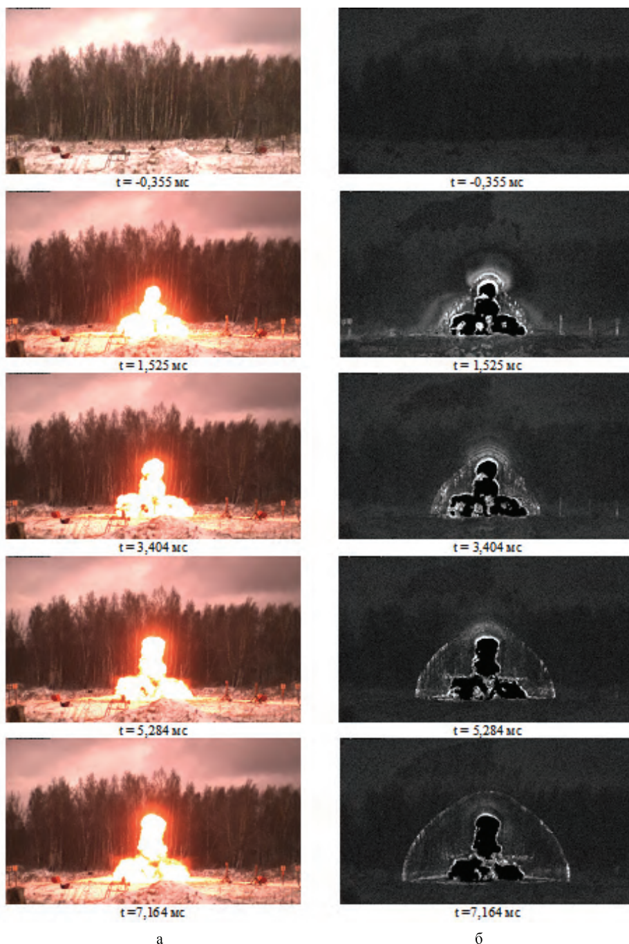
Рис. 6. Изображения с видеокamеры № 2: а – фрагмент видеорегистрации; б – визуализация ВУВ
