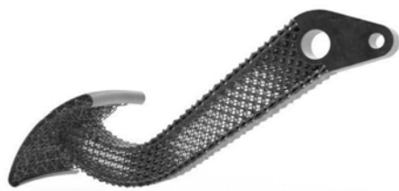
Рис. 9. Создание сложной детали (слева сверху образец из рекламной статьи, справа сверху деталь созданная в программе, а внизу деталь со вписанной решёткой внутри и экспортированная в другую программу)
