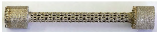
Рис. 6. Компьютерная модель и изготовленный по ней стандартный образец для исследований на растяжение со вписанной решёткой (до постобработки, длина 58 мм)
