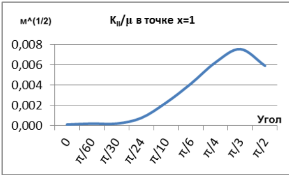
Рис. 7. Зависимость коэффициента K_{II} от угла между трещинами
