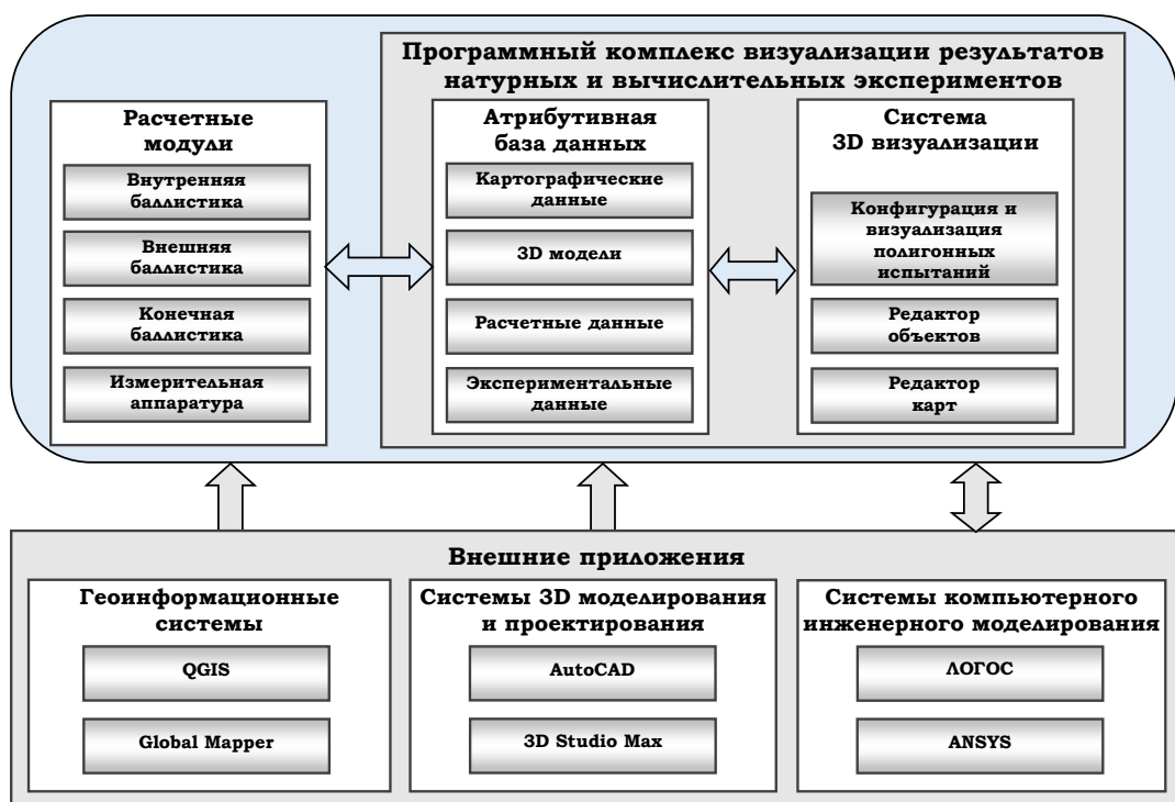
Рис. 16. Структура программного комплекса моделирования и визуализации баллистических процессов
