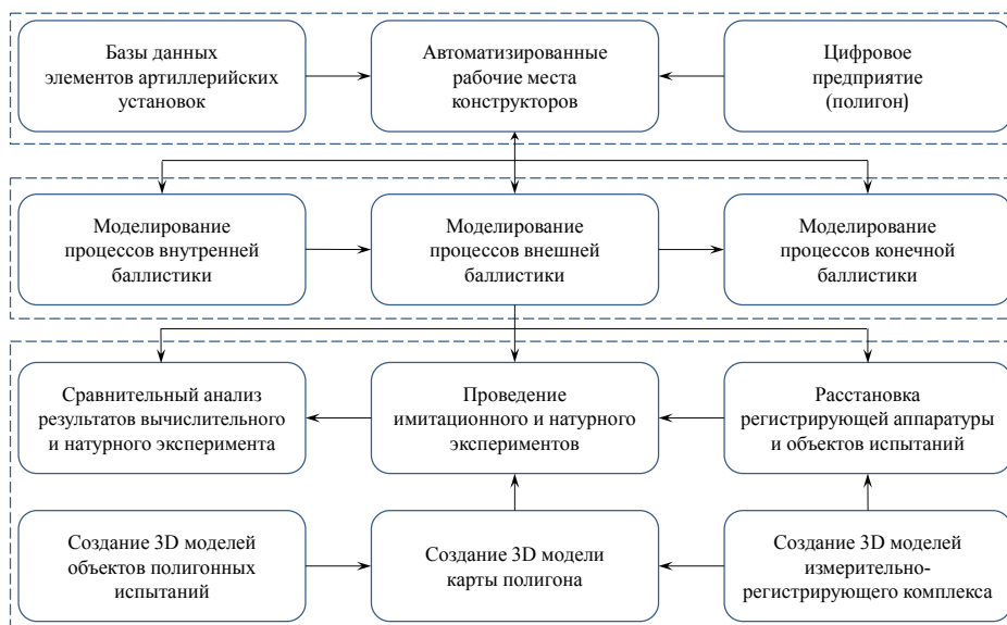
Рис. 9. Взаимосвязь процессов проектирования, моделирования и полигональных испытаний артиллерийских систем
