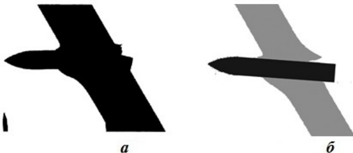
Рис. 12. Пробивание преграды при V_0 = 0,573 км/с: a — рентгенограмма опыта, t = 152,8 мкс; б — поле плотности в расчете ЭГАК, t = 160 мкс
