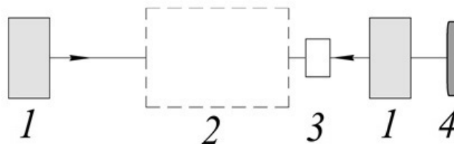
Рис. 3. Схема измерения КУ генерационным методом: 1 – зеркала; 2 – квантрон; 3 – фильтры; 4 – визуализатор
