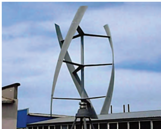
Гелиоидный ротор. Генератор Горлова
