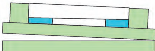
Задание начального возмущения жидкого кольца путем наклона модели на малый угол
