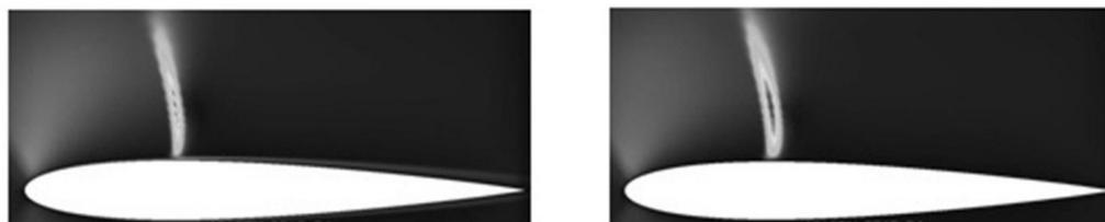
Рис. 5. Трансзвуковое обтекание профиля *NACA0012*. Поле распределения функции критерия для плотности (слева) и давления (справа)
