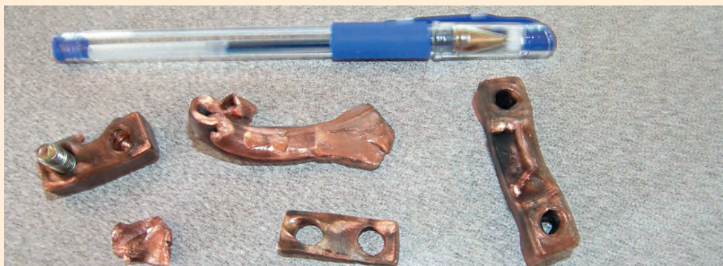
Медный электрод после разрушения
