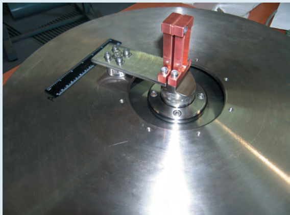
Макет ударно-волновой нагрузки с медными электродами
