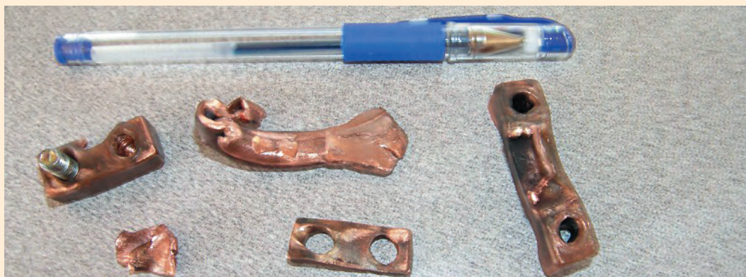
Медный электрод после разрушения
