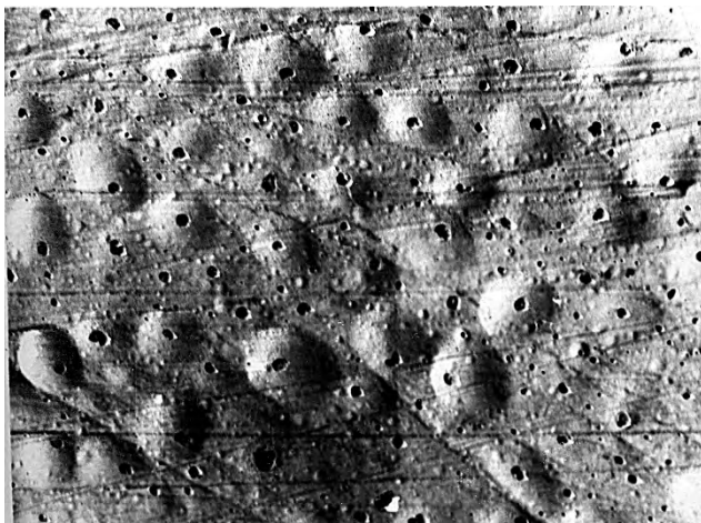
Рис. 7. Блистеры на лейкосапфире ( \text{H}^+ , E_i = 10 \text{ кэВ} , \Phi_{\text{обл}} = 1 \cdot 10^{18} \text{ ион/см}^2 , T = 400 \text{ К} )
