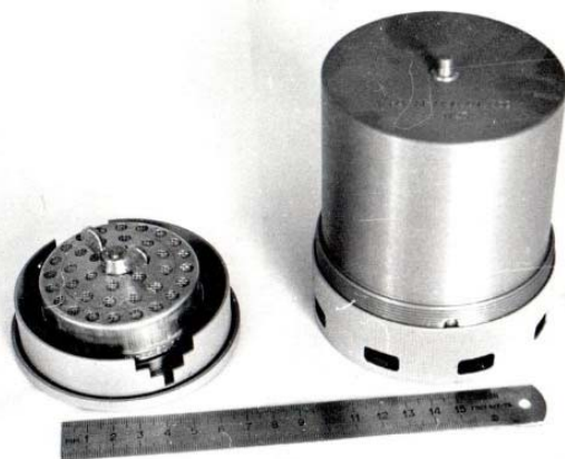
Рис. 10. Сорбционные элементы, размещаемые в боксе (контейнере)
