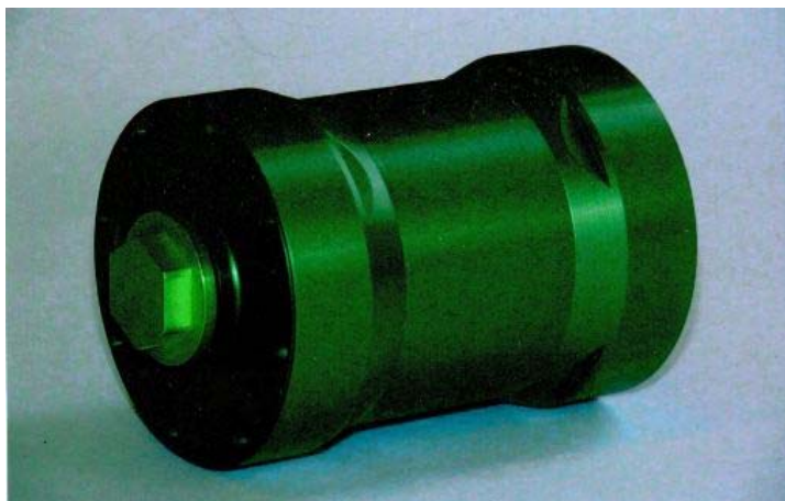
Рис. 4. Пассивный воздушный пробоотборник трития и его соединений
