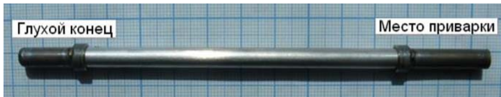
Рис. 2. Образец трубчатой мембраны из двойного ОЦК сплава ванадия с палладиевым покрытием внешней и внутренней сторон (для наглядности на фотографии представлен образец мембраны более короткой, чем использованная в данном эксперименте)
