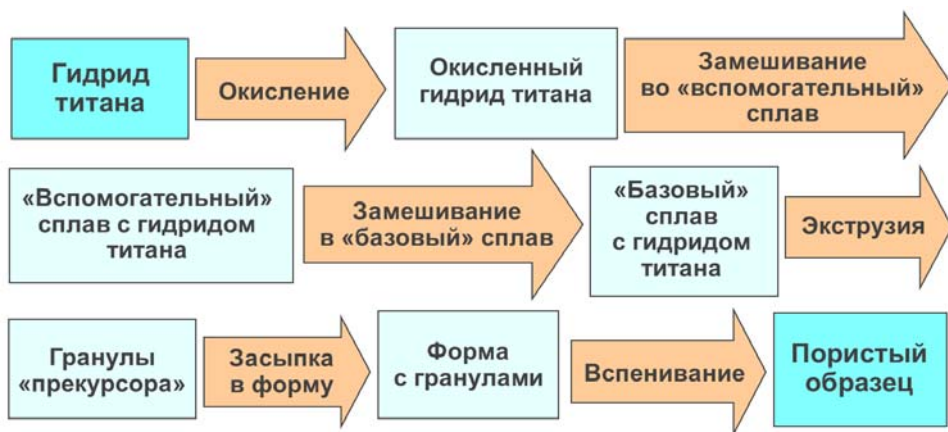
Рис. 6. Схема получения образцов из алюминиевой пены с использованием TiH_2 , разработанная сотрудниками РФЯЦ-ВНИИЭФ и ОАО «ВИЛС»
