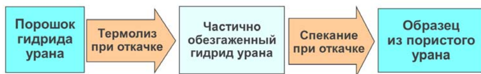
Рис. 7. Выбранная схема получения образцов пористого урана
