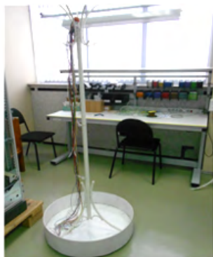
Рис. 1. Изготовление поддона для проводов под стремянку для монтажа
