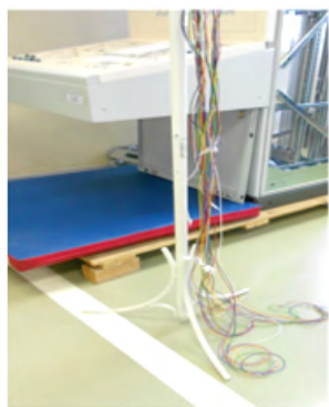
Рис. 1. Изготовление поддона для проводов под стремянку для монтажа
