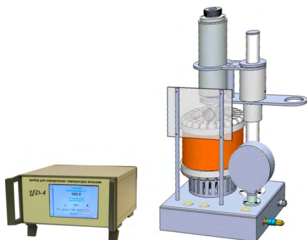
Рис. 3. Оборудование для определения температуры вспышки
