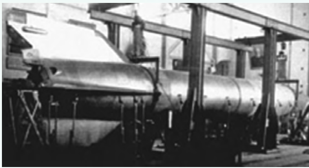
НИИ-88. Вибрационные испытания ракеты Р-2
