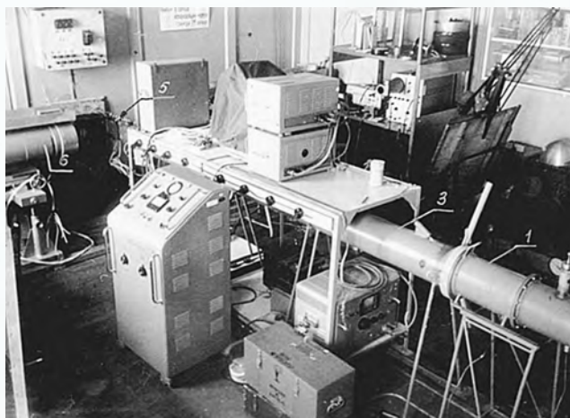
Установка с ударной трубой, ИАБ-451 и камерой СФР в комнате № 4
