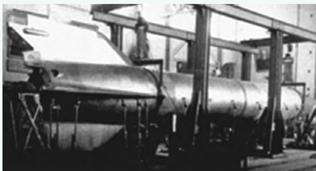
НИИ-88. Вибрационные испытания ракеты Р-2
