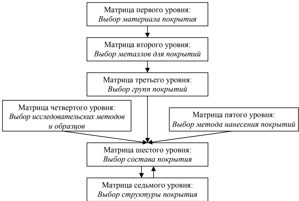
Рис. 4. Модель многоуровневой параметрической матрицы испытаний и исследований
