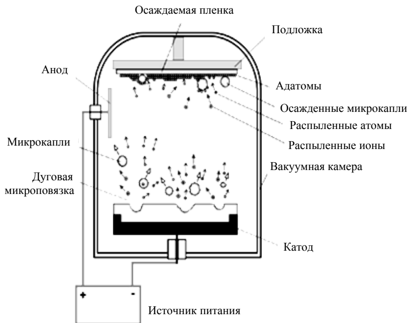
Рис. 1. Принципиальная схема нанесения покрытия методом вакуумного дугового напыления
