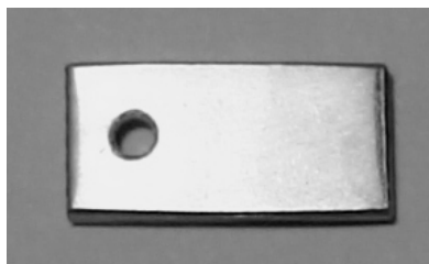
Рис. 1. Образец-свидетель: циркониевая пластинка
