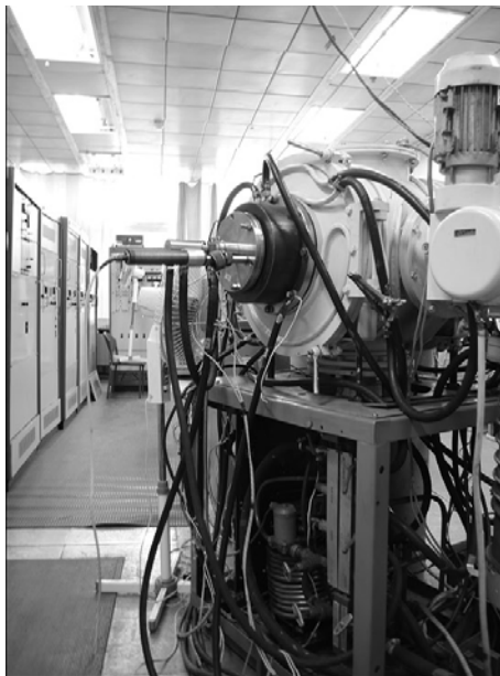
Рис. 3. Модифицированная установка «Булат-6». Оборудование, которое применялось, представляет собой серийную промышленную установку, оснащенную доработанными источниками питания с более высокой стабильностью параметров, механизмами подавления паразитных микродуг и доработанными блоками управления
