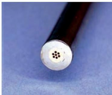
Рис. 3. Схема «six-around-one» расположения волокон оптического зонда «Avantes»
