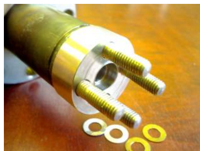
Рис. 3. Ячейка для экспериментов по водородопроницаемости циркониевого сплава
