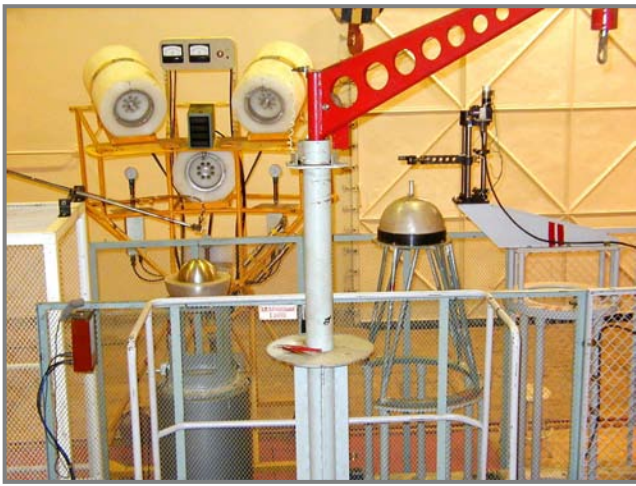
Рис. 2. Стенд ФКБН-2М с размножающей сборкой в экспериментальном зале
