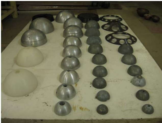
Рис. 3. Набор макетных деталей из делящихся и конструкционных материалов для сборки критических систем на установке ФКБН-2М
