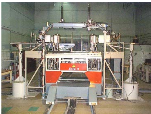
Рис. 3. Двухзонный импульсный реактор БАРС-5. Расстояние между центрами АЗ составляет 150 см, минимальное – 37 см (зазор между АЗ «в свету» равен 10 см)
