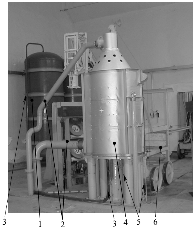
Рис. 1. Импульсный реактор БИГР: 1 – ресивер РС1, 2 – трубопроводы системы охлаждения аппарата БИГР, 3 – трубопроводы газовакуумной системы, 4 – реактор (внешняя оболочка – кадмиевый экран), 5 – трубопроводы системы дозконтроля, 6 – тележка для облучаемых образцов
