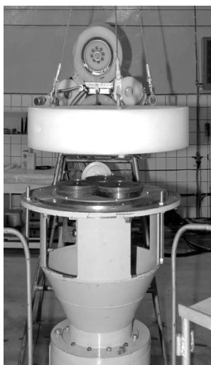
Рис. 11. Критическая сборка из урана с односторонним отражателем из полиэтилена с имитацией АЗ большого диаметра
