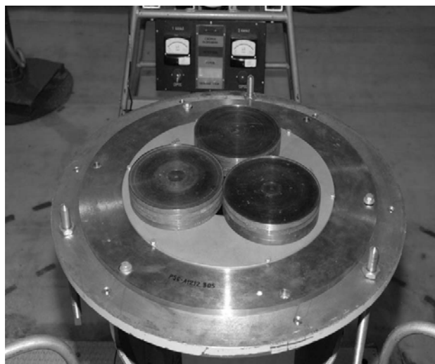
Рис. 11. Критическая сборка из урана с односторонним отражателем из полиэтилена с имитацией АЗ большого диаметра
