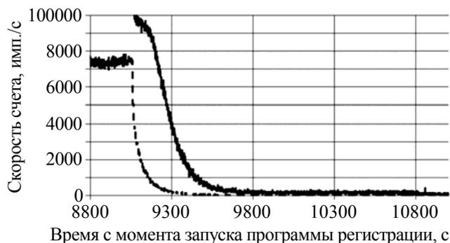
Рис. 4. Переходный процесс после сброса источника нейтронов (— — — штатный ИК, — — — новый ИК)
