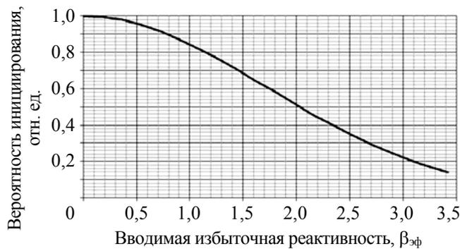
Рис. 7. Зависимость вероятности реализации полного запаса реактивности от вводимой избыточной реактивности
