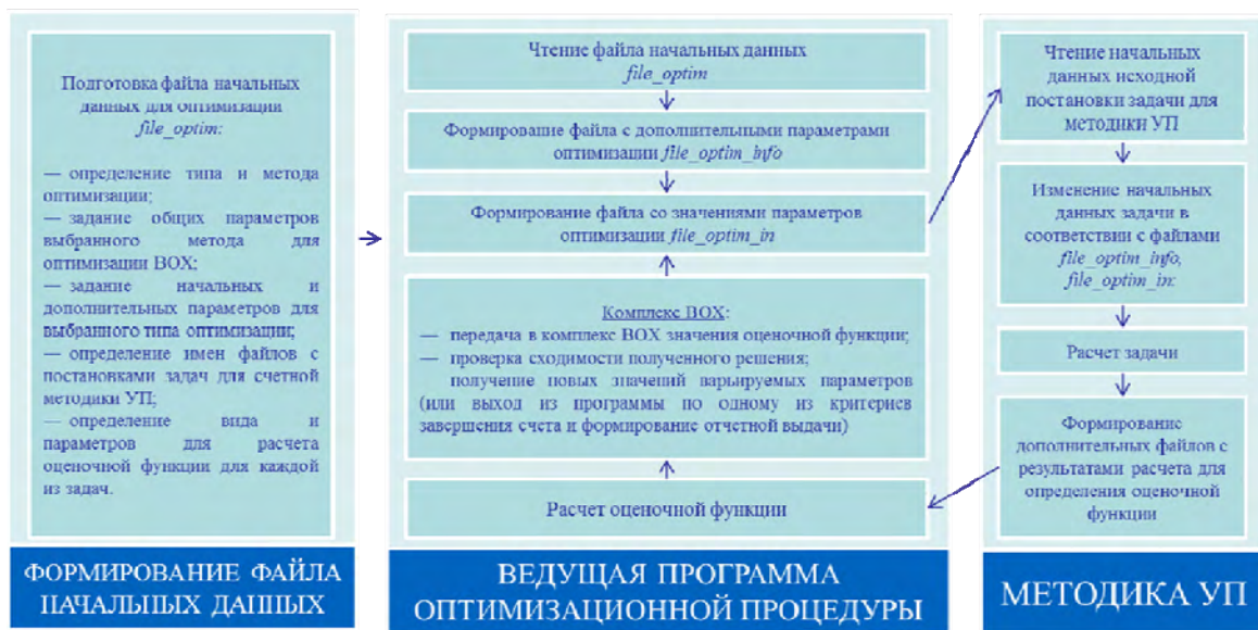
Рис. 1. Общая структура и последовательность выполнения оптимизационного расчета с помощью метода BOX
