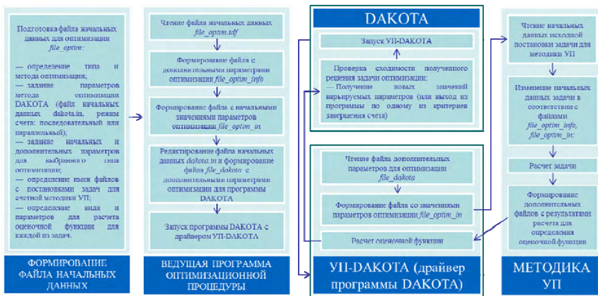
Рис. 2. Общая структура и последовательность выполнения оптимизационного расчета с помощью программ свободной библиотеки DAKOTA
